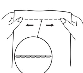
Эта строчка формируется из двух прямых стежков и одного обратного. Такой шов нелегко разорвать. Используйте его в области проймы и втачивания рукавов. Можно также использовать при шитье рюкзаков для повышенной прочности.
