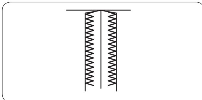
Простой зигзаг используется для обработки (обмётки) краёв большинства тканей во избежание осыпания.
