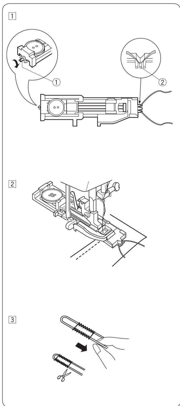
1 Поднимите лапку для автоматической петли, набросьте жгут на крючок сзади лапки. Переведите концы шнура вперёд, заправив под лапку. Нацепите жгут на вилку спереди лапки для надёжной фиксации.
